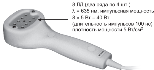
Рис. 3.5. Матричная лазерная излучающая головка МЛ-635-40
